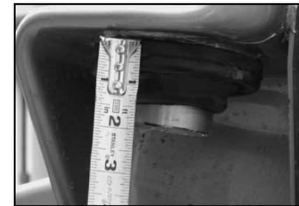
FIGURE 10.2 FRONT BUMPSTOP STUB MUST BE TRIMMED AS SHOWN
